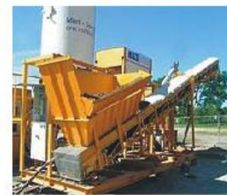
mobile Flüssigbodenstation. Rückverfüllung mit Betonmischer oder Betonpumpe
